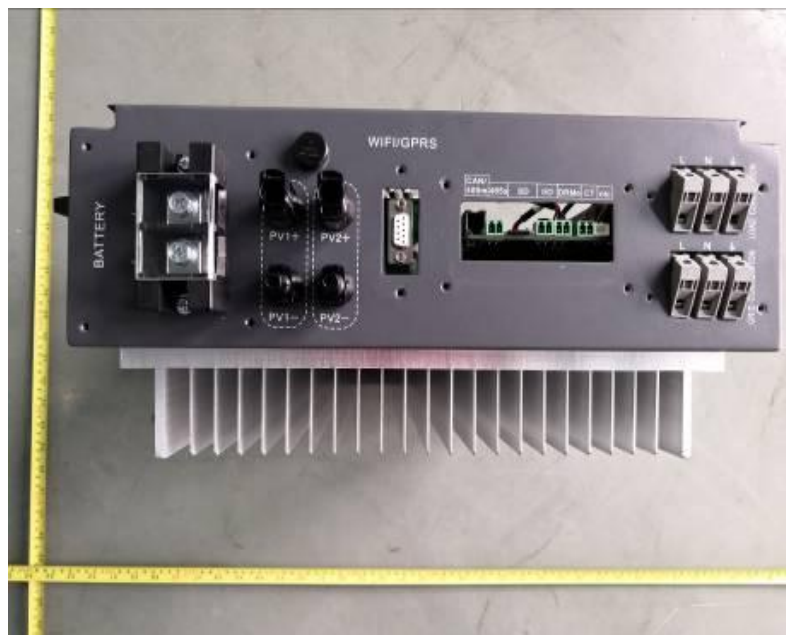
Figura 2, Vista do painel de terminais
